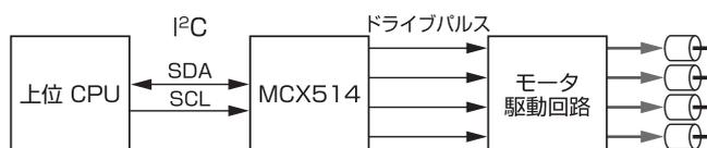
上位CPUとの接続に従来の8ビットデータバス、16ビットデータバスの他にI<sup>2</sup>Cシリアルインターフェイスバスを備えています。同一バス上に、MCX514を最大8個まで接続可能です。
