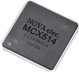
MCX514は上位CPUと8ビット、16ビットバスまたはI<sup>2</sup>Cシリアルインターフェイスバスで接続し、パルス列入力のサーボモータ、ステップモータを位置決め制御、または速度制御ができる補間機能付き4軸モーションコントロールICです。
